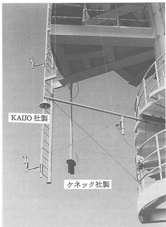
写真-2 空中発射式超音波波高計
