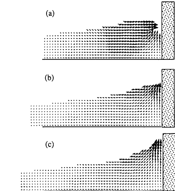
図5 衝撃波圧発生前後の流速ベクトル (位相間隔; 20t/T , L_s=3.1 )
