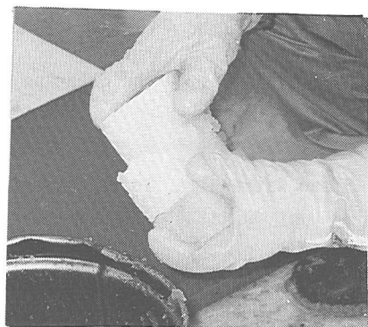
図2 付着力試験片製作状況
