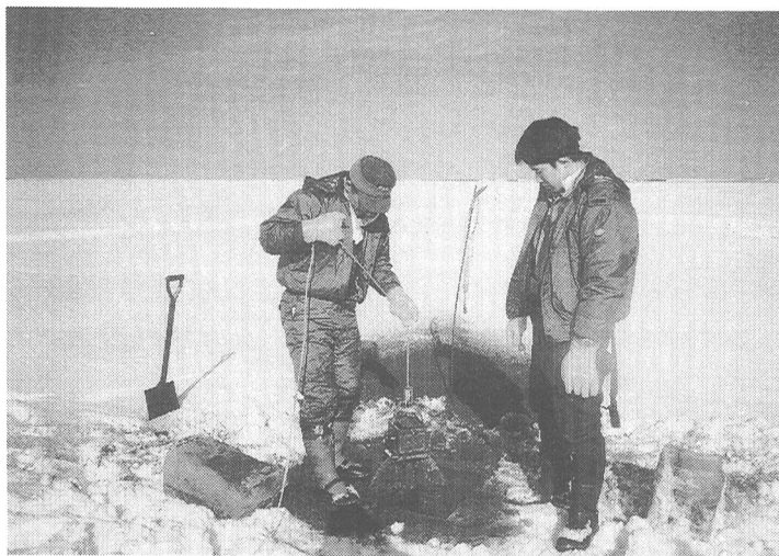
写真－3 結氷時の底質採取
