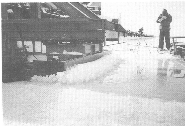
写真-1 試験時の氷盤破壊状況 (供試模型幅W=3.0m、氷厚12cm)
