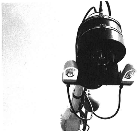
写真-2 超音波凹凸形状計測装置付き水中テレビ
