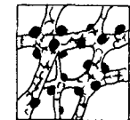
図-5 セメントゲル中での顔料粒子(モデル図)
