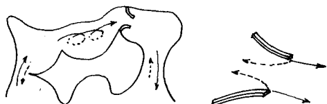
図7. 導流堤による潮流制御
