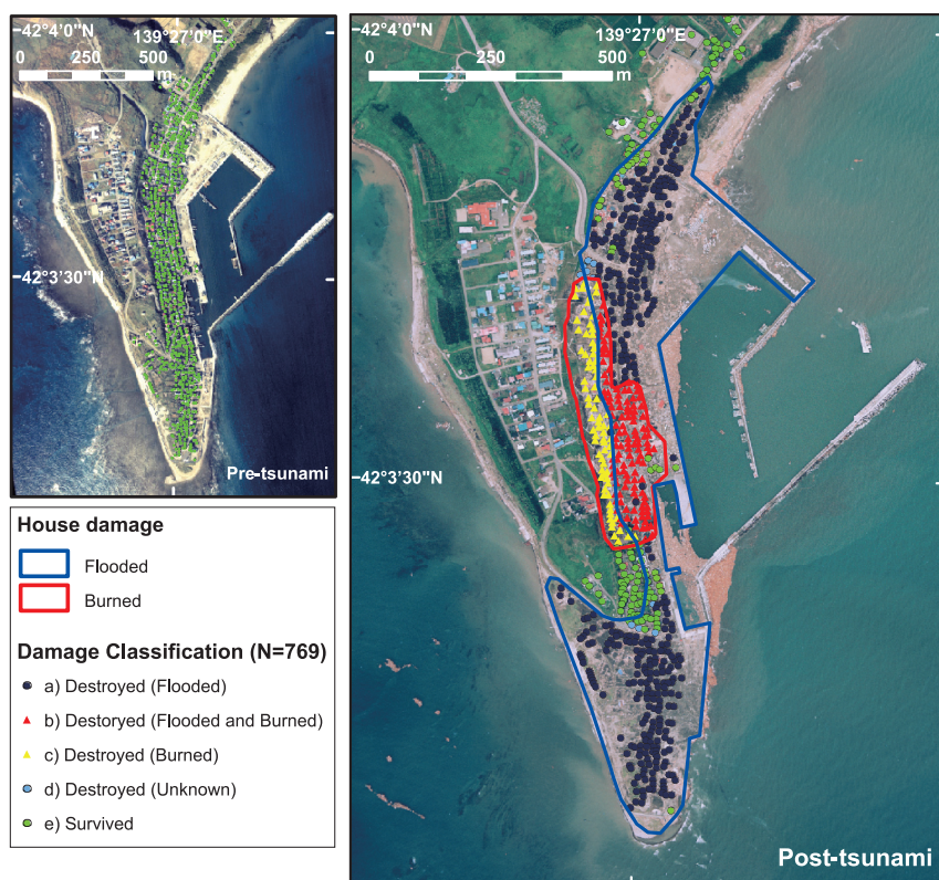
図-3 航空写真の判読による奥尻島青苗地区の家屋被害の分類 (図中のラインはShuto (2007) で報告された津波浸水域と火災域)
