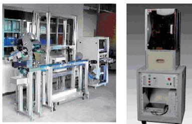
図-4 着色砂分析システム (1型, 2型)
