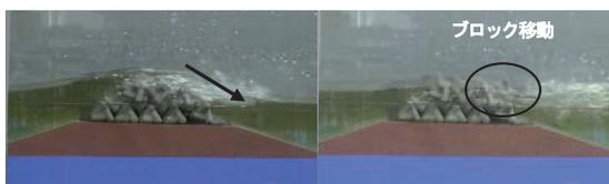
写真-1 離岸堤単独の越波時の背後ブロック移動状況
