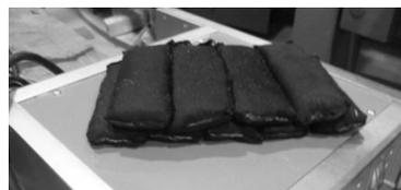
写真-1 サンドバック群を用いた潜堤
