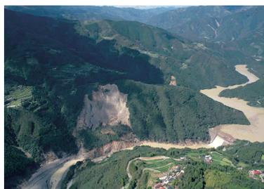
写真-1 塚原ダム直下における大規模斜面崩壊 (宮崎県提供)
