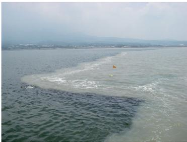
写真-1 淡水のフロントにトラップされた漂流ブイの状況
