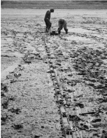
図-5 MASWによる探査の実施状況
