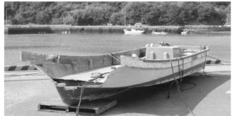
写真-5 転覆時に舳先が護岸に衝突して破損した漁船
