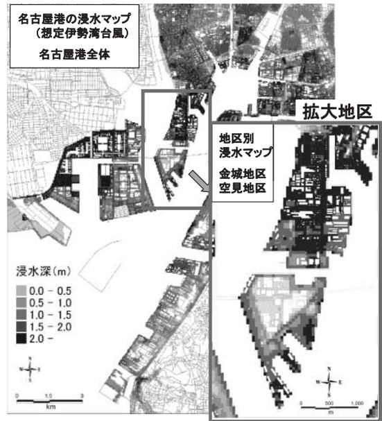
図-10 最大の浸水被害を発生させるシナリオによる名古屋港の高潮浸水図 (CASE1: 台風強大化)
