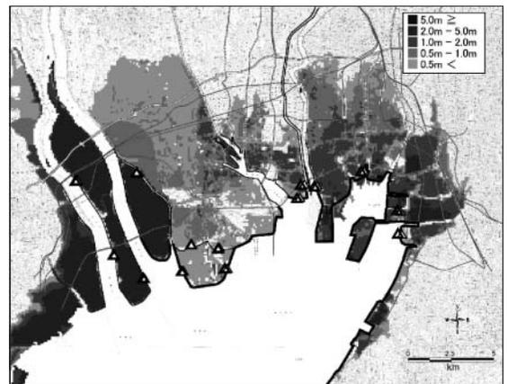
図-4 高潮浸水シミュレーションによる伊勢湾台風来襲当時の伊勢湾奥部沿岸における浸水域の追算
