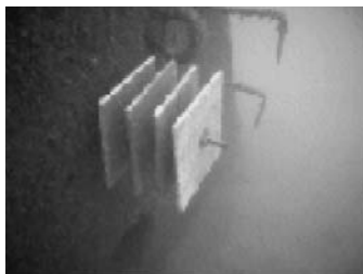
写真-2 着生板の固定状況
