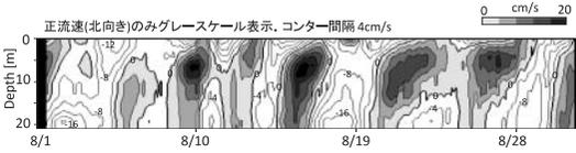
(d)河口沖 (M2)の残差流時空間コンター (南北成分)の計算結果
