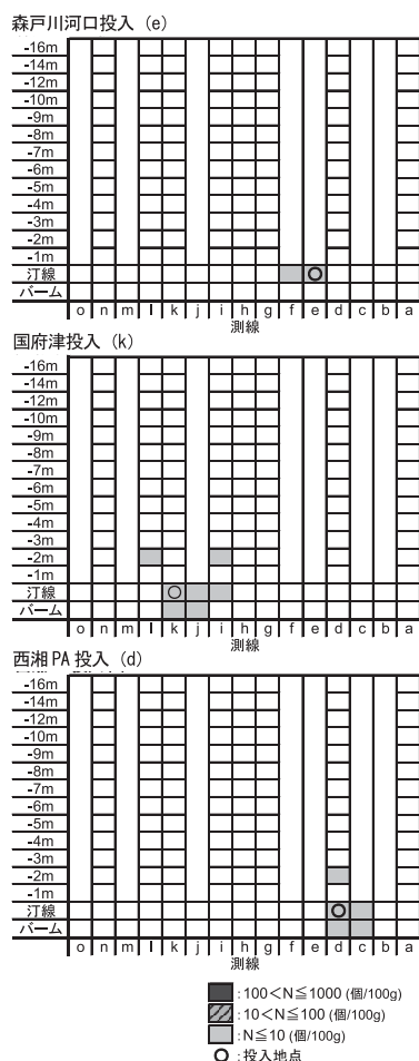
図-9 粒径2mmのカラーサンドの広がり状況(3回目の観測結果)
