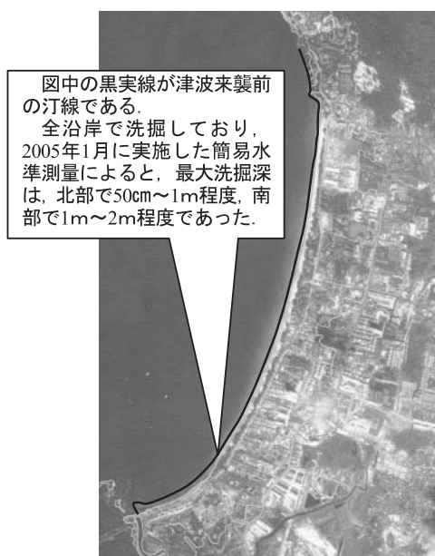
写真-1 Patongビーチでの洗掘状況 (IKONOSによる撮影2004年12月29日)
