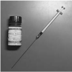
写真-1 染料と染料を砂中に注入する注射器
