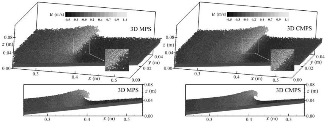
図-1 3次元MPSおよびCMPS法による巻き波発達過程のシミュレーション
