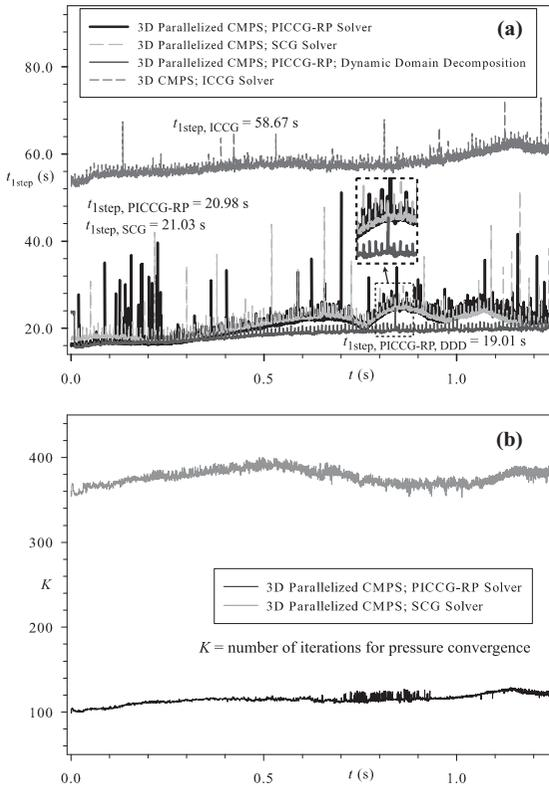
図-5 計算時間の比較 ((a) 時間ステップあたりの計算実行時間の時系列; (b) 圧力Poisson方程式計算反復回数の時系列)
