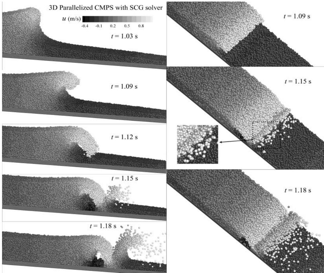
図-3 3次元CMPS法の並列計算(SCG法)によるfingerの再現
