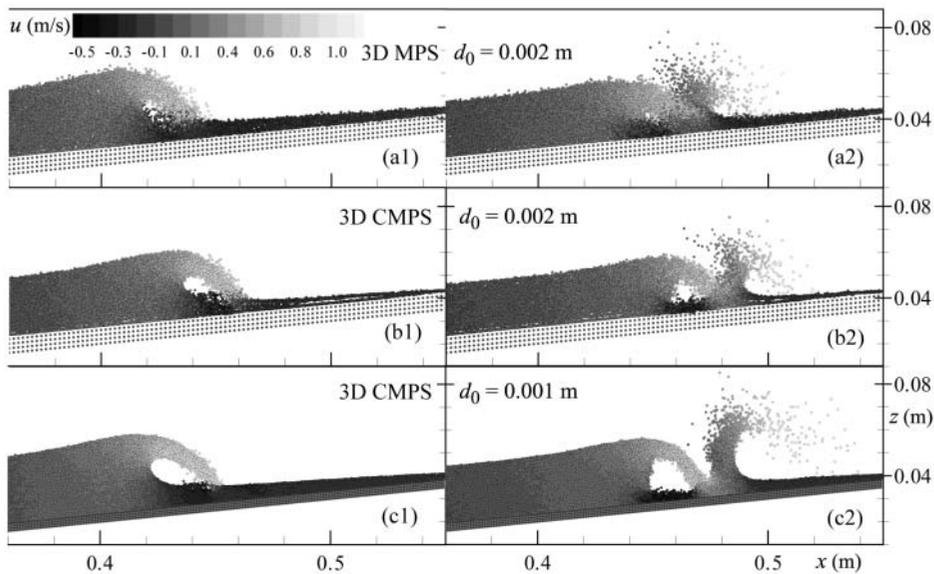
図-2 plunging jetの水面衝突と splash-up 過程のシミュレーション
