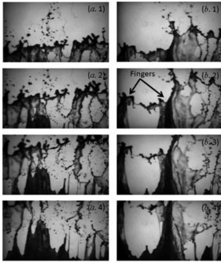
図-4 z = 24\text{cm} におけるFlip-throughジェットの発達過程 (左:帯状ジェット, 右:フィンガー状ジェット)
