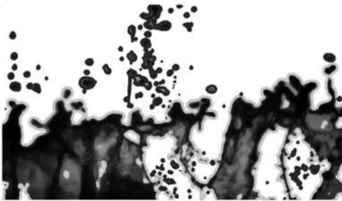
図-2 Level-set法により検出された流体エッジ画像（黒線：飛沫のエッジ、灰色線：ジェットのエッジ）
