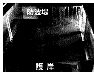
図-2 港湾模型と波高計・流速計アレイ
