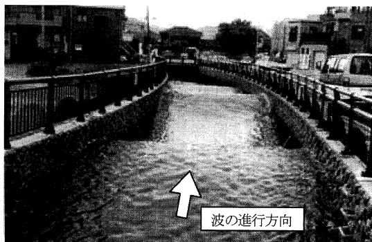
写真-1 瀬上川に遡上する長周期波(先端部でソリトン分裂が出現しているように見える)
