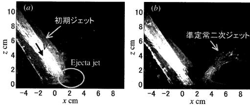
図-2 水槽側方から撮影した(a)ジェット-水面間のコンタクトラインから噴出するejecta jet( $t=0.006$ s)と、(b)その後発達する大規模な準定常二次ジェット( $t=0.026$ s)。
