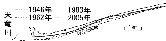
図-2 河口部左岸(竜洋海岸・磐田海岸)の汀線変化 (×:旧掛塚灯台, ●:掛塚灯台移設位置, 細実線は海岸堤防)
