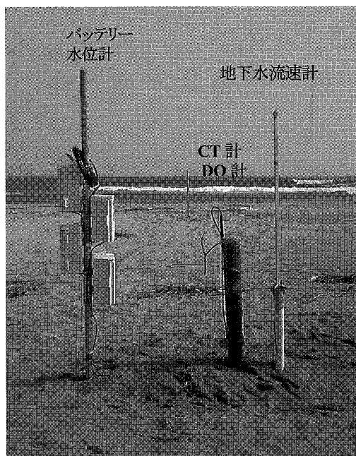
図-2 計器の設置状況
