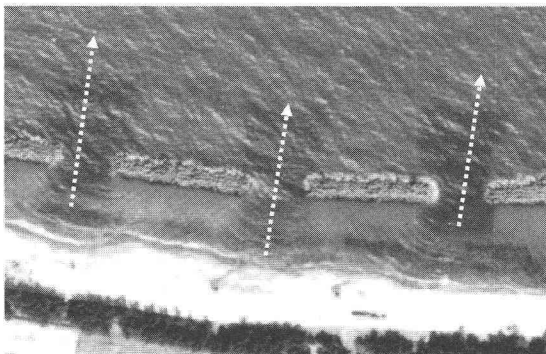
図-1 離岸流を引き起こす離岸堤間リップチャンネル
