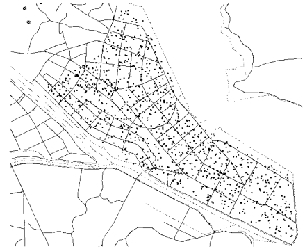
図-4 避難シミュレーションで用いたノード・リンクモデルと避難者の初期配置
