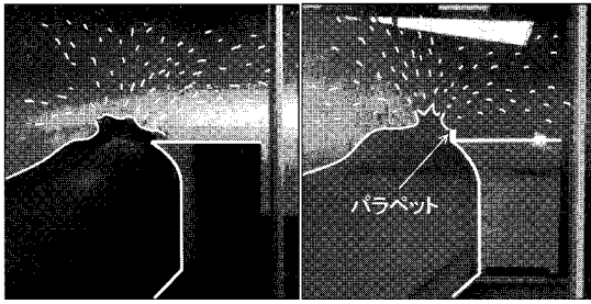
図-7 パラベットによる飛沫低減効果の確認実験の様子
