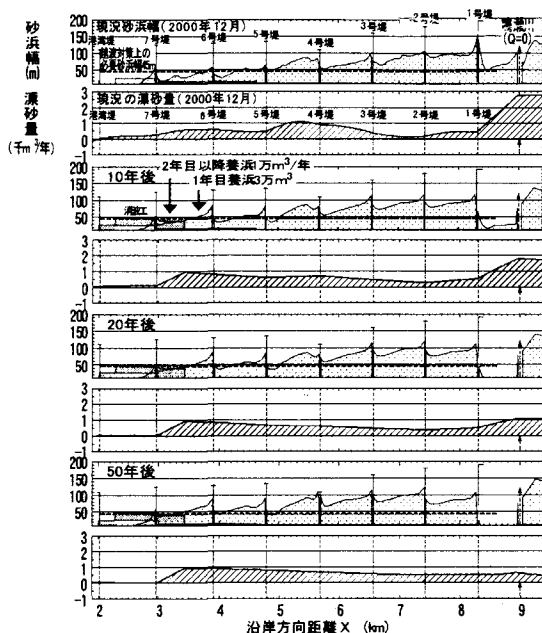
図-10 養浜案2の予測計算結果(砂浜幅・漂砂量の沿岸分布)
