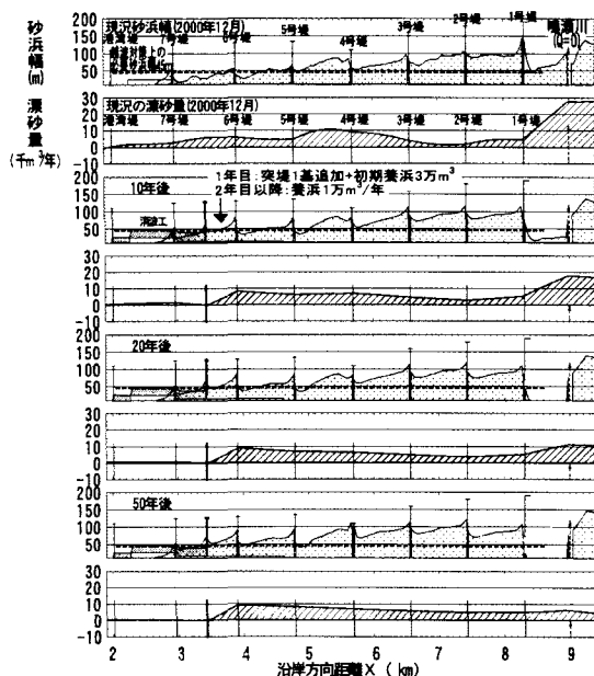
図-9 養浜案1の予測計算結果(砂浜幅・漂砂量の沿岸分布)
