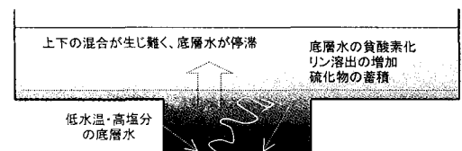
(1) 底層水停滞による水質悪化の機構
