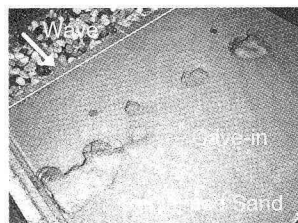
(b) パターン③：傾斜型捨石護岸背後に生じた陥没 ( H_i/L=0.019 , B/L=0.314 , h/L=0.169 , Ur=4.0 )
