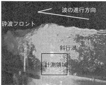
図-8 碎波フロントと斜行渦発生位置を撮影したスナップショット (図-7 の位相と対応する)
