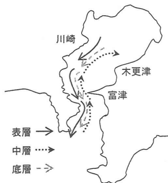
図-6 中層貫入現象発生時の流動構造の概念図
