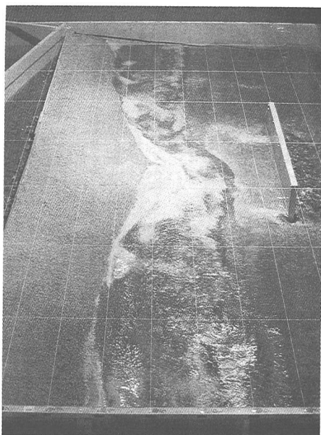
写真-1 離岸堤背後の舌状砂州の形成状況
