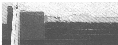
写真-1 越波水塊の打ち込み状況
