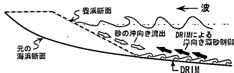
図-1 DRIM による養浜砂の流出防止対策
