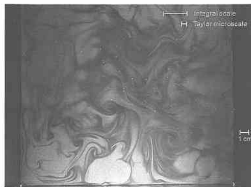
図-5 水平断面におけるCO 2 吸収過程
