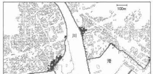
図-6 津波発生後42分時の浸水状況
