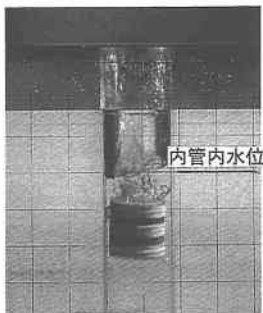
写真-1 単式鉛直管内での 水位低下状況
