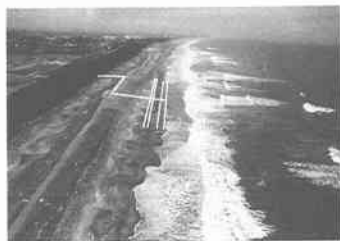
写真-3 BMS による堆砂状況 (8月28日午後2時)
