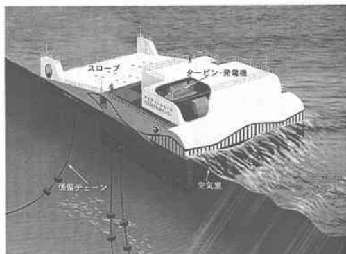
図-1 沖合浮体式波力装置「マイティーホエール」
