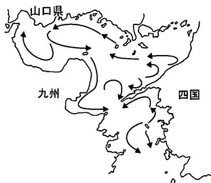
図-5 実測を基にした残差流(柳・樋口, 1979)
