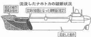
図-1 ナホトカ号破断位置 (北国新聞より)
