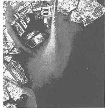
図-1 荒川における洪水流出中に現れる大規模渦構造 (1986.8.6)
