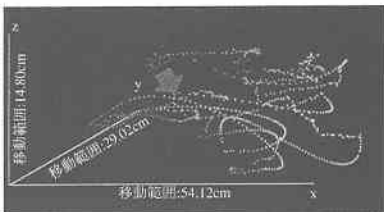
図-5 砕波後 280 cm における中立粒子移動軌跡 ( x_0 = 280 cm, y_0 = -15 cm, z_0 = -5 cm)
