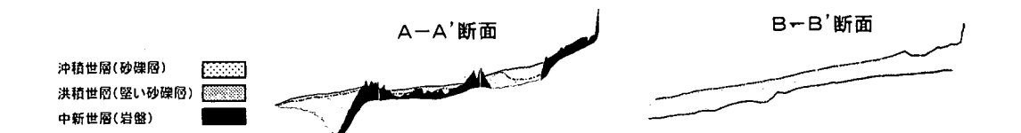
図-7 A-A'とB-B'の砂層厚断面分布
